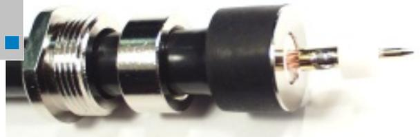
Innenstift (Pin 2, 3,0mm Ø) auf den Innenleiter stecken und sorgfältig verlöten. Anschließend Teflon-Isolator aufstecken. Hinweis: Pin 1 (2,8 mm Ø) ist für AIRCOM PLUS bestimmt.
