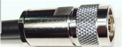
Das so vorbereitete Kabelende bis zum Anschlag in das Steckergehäuse einschieben. Mit zwei Maulschlüsseln 17 mm und 18 mm die Spannmutter handfest anziehen. Ein kleiner Spalt zwischen Mutter und Steckergehäuse sollte noch sichtbar sein!
