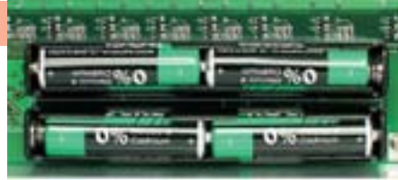
Vier Mignonzellen sind ab Werk eingebaut und für die Stromversorgung zuständig. Möglich wird dies, weil die bistabilen Relais der SG-211 nur beim Abstimmprozess Strom verbrauchen und danach bis zum nächsten Frequenzwechsel in Warteposition gehen.
