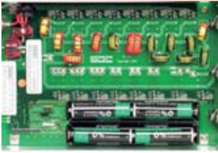
Blick aufs Innenleben des SG-211. Der Automatiktuner benötigt keine externe Steuerleitung.
